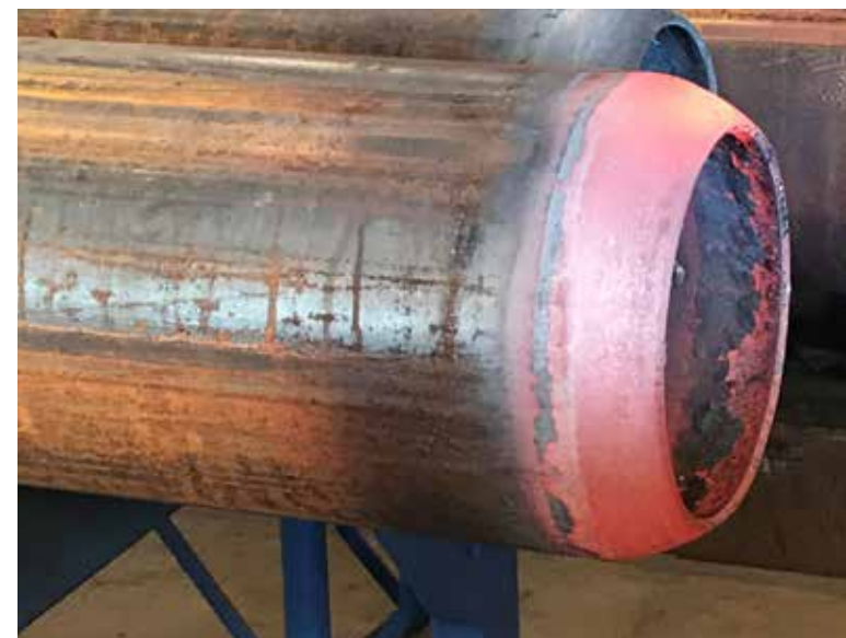
buisdeel wordt koud of warm getrompt
